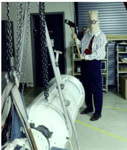
图 3a 对悬挂点接近第 1 阶弯曲模态节点的导弹进行锤击测试
