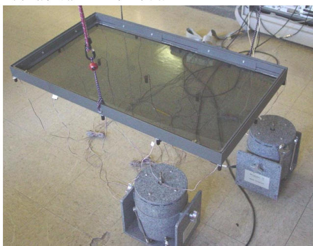
图 1 带加强筋的平板结构
