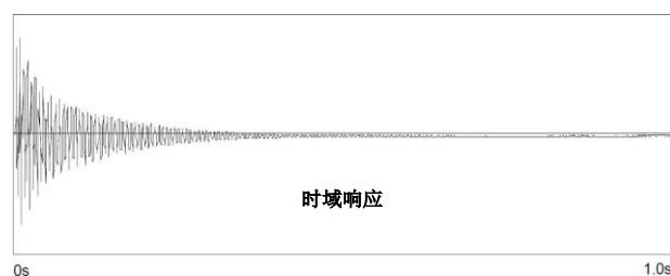
图 2 800Hz 带宽内的时域响应信号
