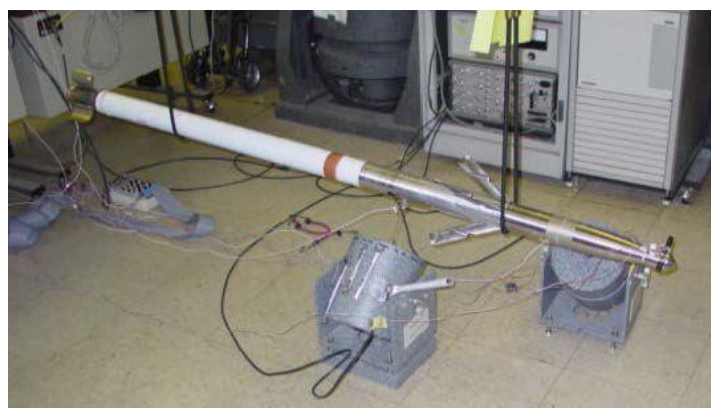
图 3b 对悬挂点接近第 1 阶弯曲模态节点的导弹进行激振器测试
